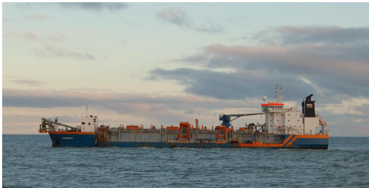
Рисунок 5 — Дноуглубительные работы в Байдарацкой губе. Самоотвозной земснаряд UTRECHT. 2009 год
