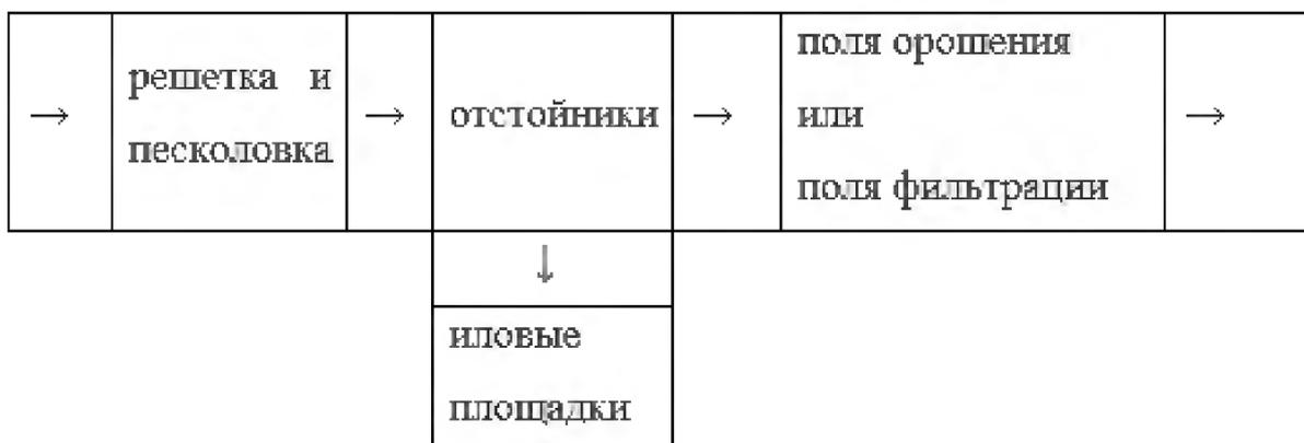
Рисунок 3.7 — Типовая схема очистки с применением поля орошения
