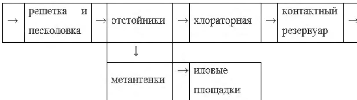
Рисунок 3.6. — Типовая схема очистки с применением метантенки
