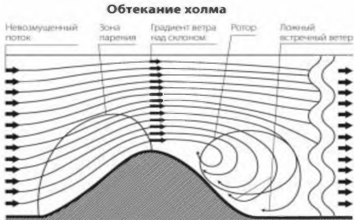
Рисунок 2.9 — Схема обтекания препятствий воздушным потоком
