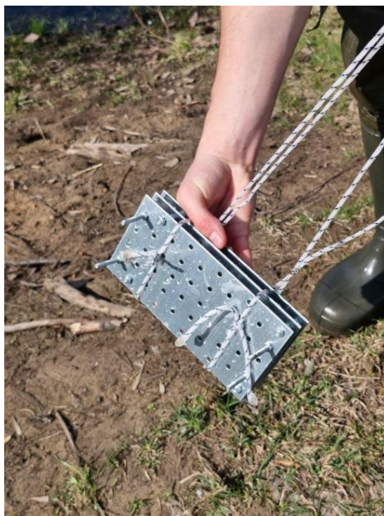
Рисунок 2.4 – строение якоря модели - прототипа два
