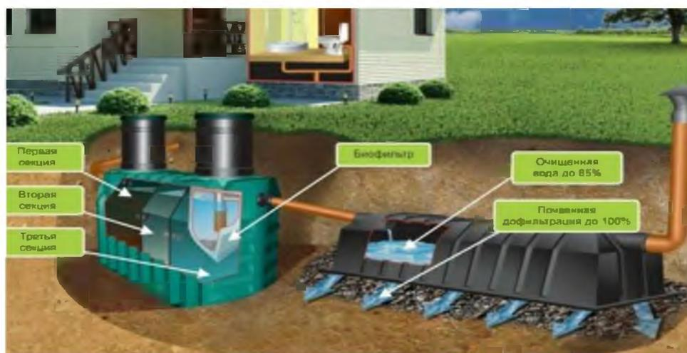
Рисунок 3.10 — Схема очистки сточных вод в септике глубокой биологической очистки с различными фильтрационными устройствами [26, с.75].
