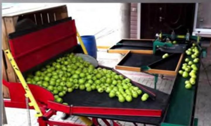
Рисунок 2.2 - Калибровочная машина
