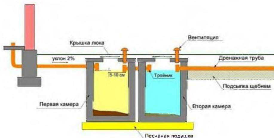
Рисунок 3.8 - Схема септика из бетонных колец [26, с.65]
