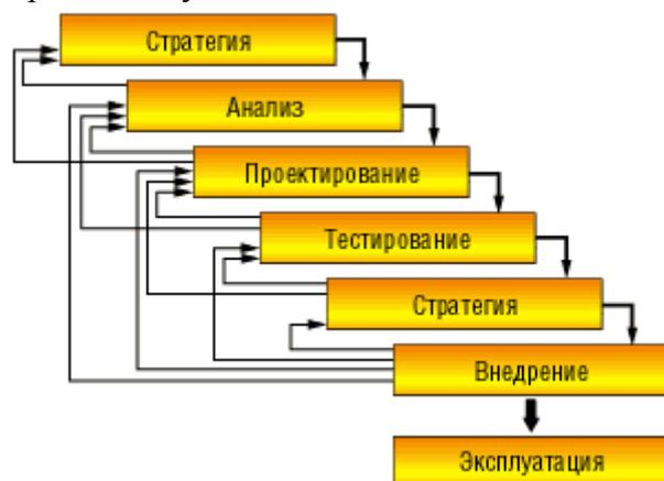
Рис. 1. Схема «водопада»
