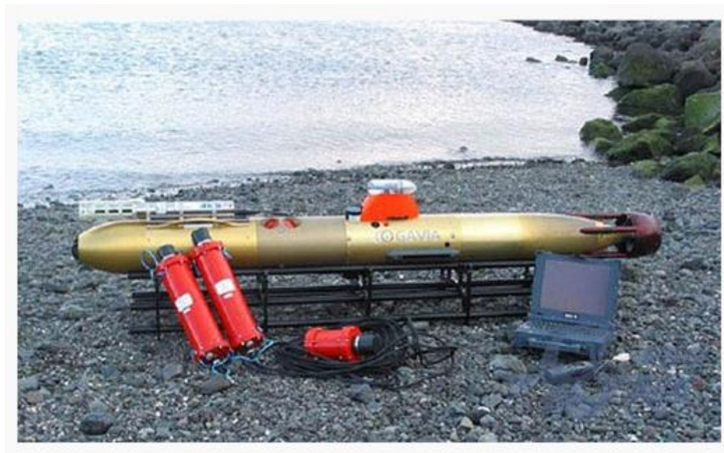
Рисунок 21 – АНПА GAVIA производства компании Hafmynd, Ирландия.
