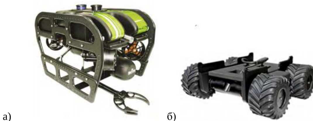
Рисунок 3. «Обзор ПРО компании Тетис 950» ПРО (а) и его прижимная колесная рама (б).
