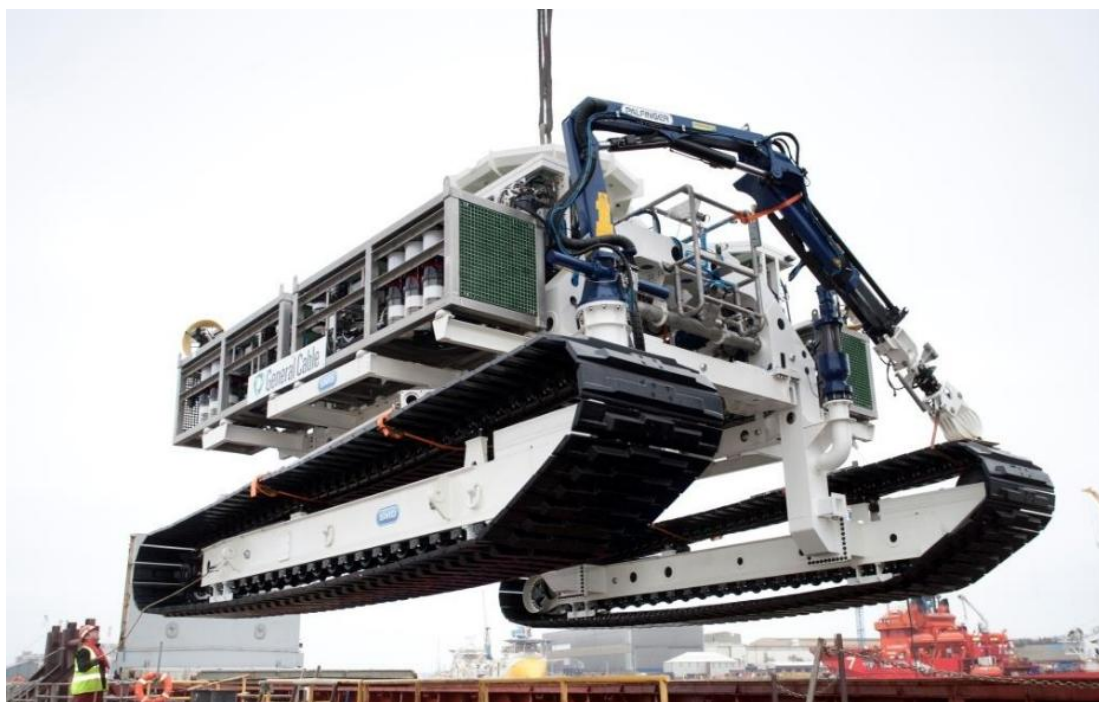
Рисунок 22 – ТНПА специального класса QTrencher 600 производства компании SMD, Великобритания.
