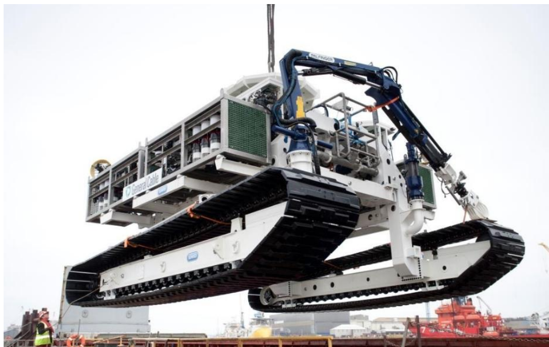
Рисунок 18 – ТНПА CABLE BURIAL TRACTOR 800 производства компании SMD, Великобритания.
