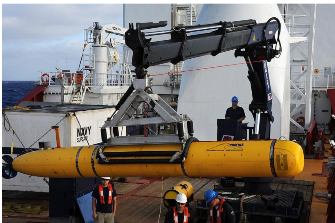
Рисунок 19 – АНПА Bluefin-21 производства компании Bluefin Robotics, США.
