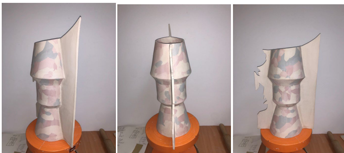
Приложение Б. 11 — Изделие после сушки. Вид перед утильным обжигом
