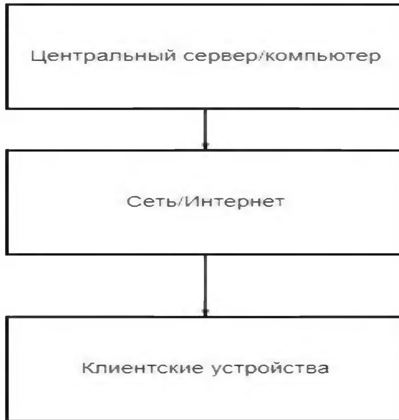
Рисунок 1.1 - Схема централизованной архитектуры
