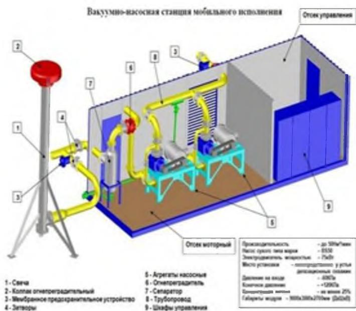
Рисунок 4 – Вакуумно-насосная станция мобильного исполнения [14, с. 115]
