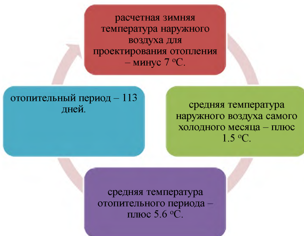
Рисунок 2.1 – Предусмотренные температурные параметры воздуха
