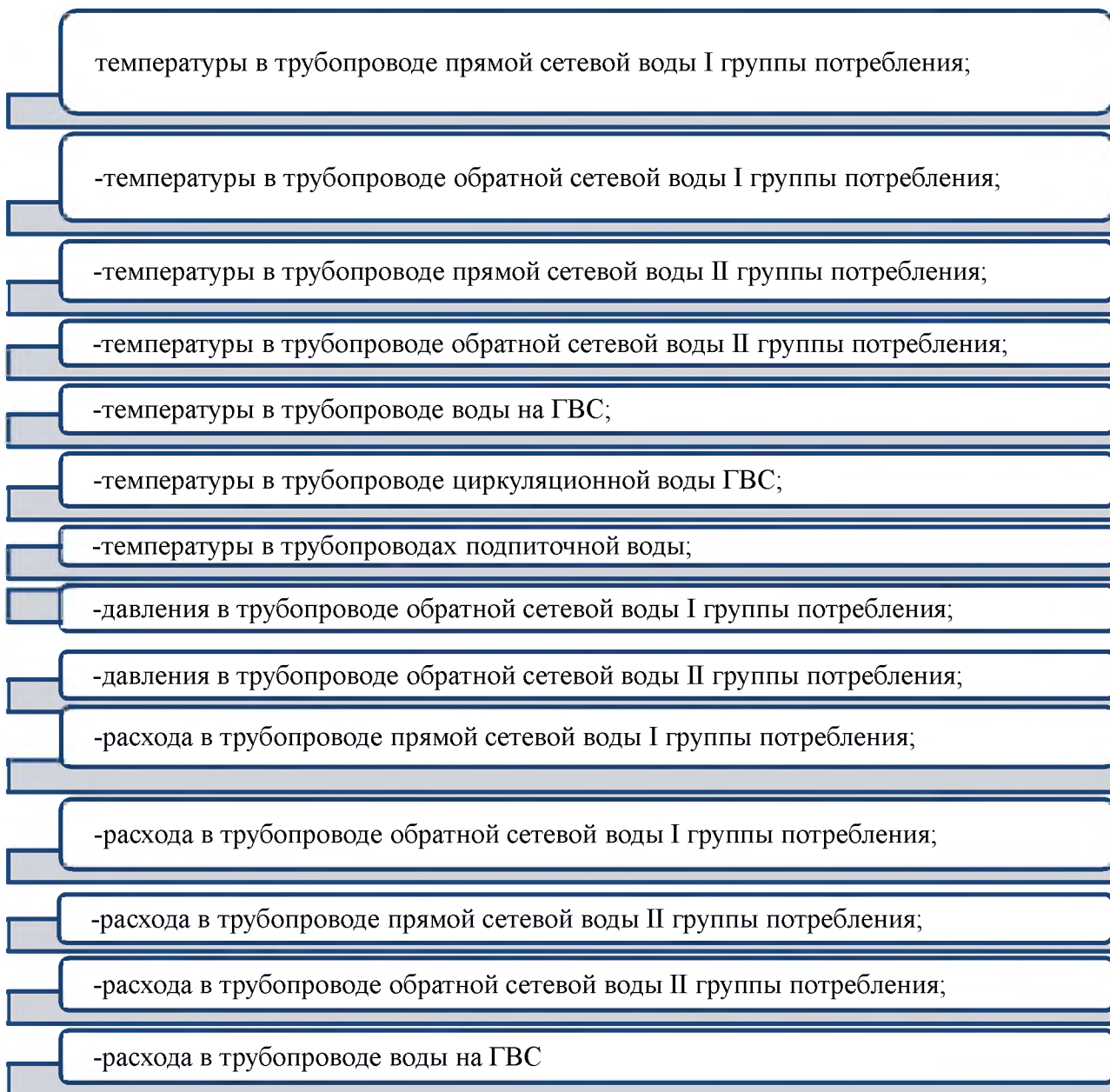
Рисунок 2.2 – Параметры измерения режимов температуры
