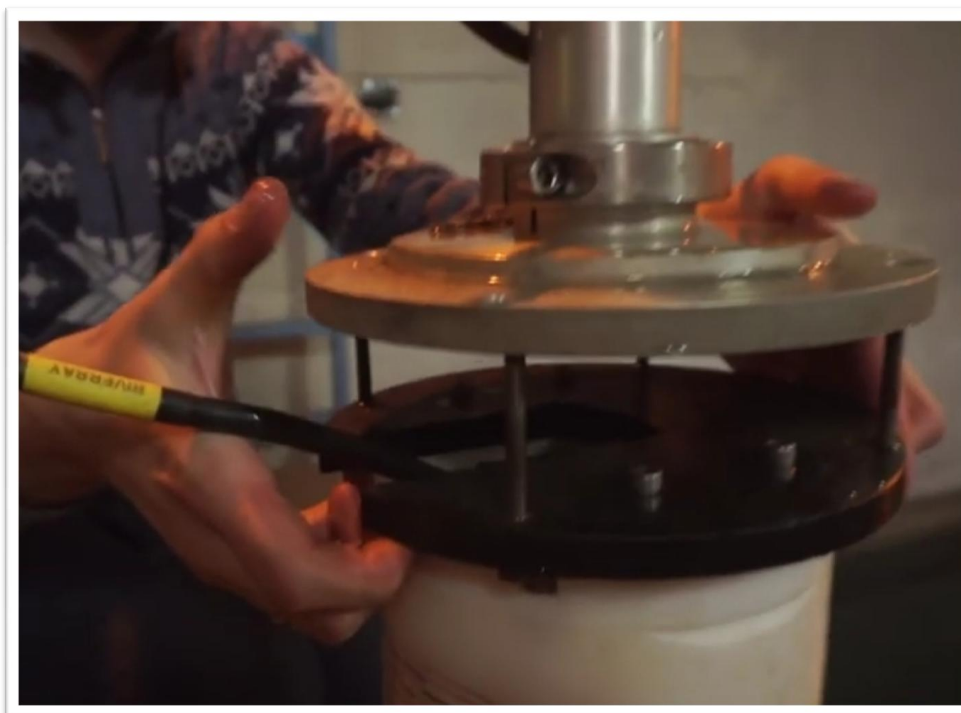
Рис. 5.3 Закрепление поверяемого профилографа на эталонной установке. ГЭБ ГГИ. (кадр из фильма о ГЭБ ГГИ)
