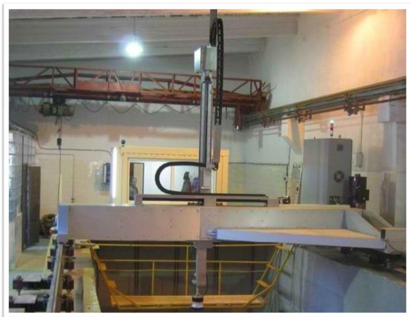
Рис.5.1 Автоматизированная гидрометрическая эталонная система для поверки профилографов потока. ГЭБ ФГБУ ГГИ. (фотография с сайта ФГБУ ГГИ).
