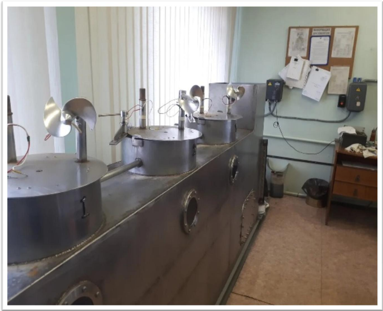
Рис.3.2 Градуировочный лоток ГР-19М в помещении для поверки гидрологических вертушек ОМСиП СИ ФГБУ «Северное УГМС». На крышках люков установлены эталонные вертушки. (фотография автора).
