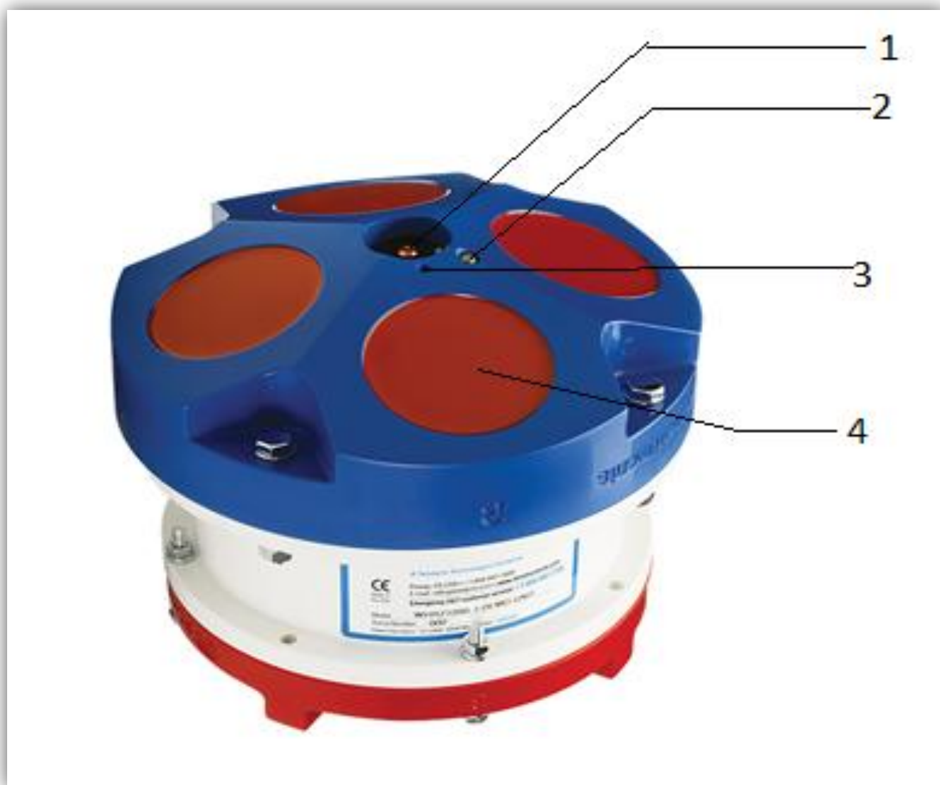
Рис.2.4 Внешний вид АДПТ "Rio Grande 1200 kHz": 1–датчик давления (200 Бар) для измерения давления воды (глубины); 2– датчик температуры воды (термистор); 3– отметка Внат-3 (3-ий луч) показывает положение третьего луча (вперёд); 4 – уретановая поверхность ке-
