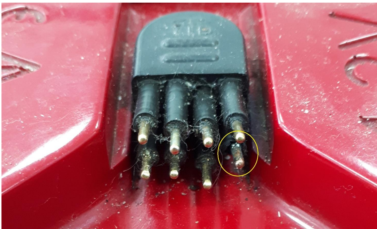
Рис.5.2 Неисправный разъём профилографа Rio Grande 1200. Кружком обведён сломанный контактный штырёк. Видны следы подгорания и окислов. (фотография автора).
