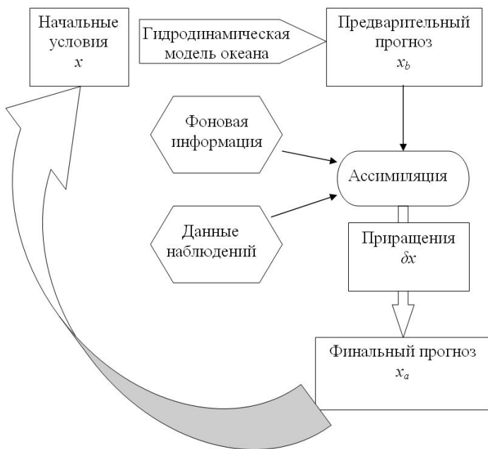
Рисунок 3.1. Общий алгоритм ассимиляционного процесса
