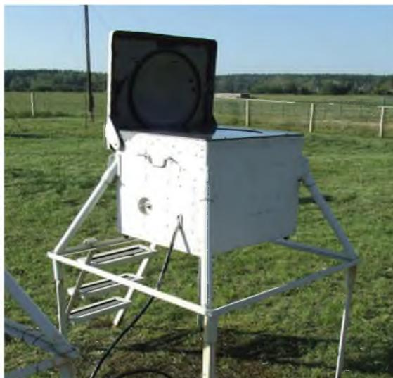
Рисунок 3.3 – Передатчик световых импульсов ИВО-1М
