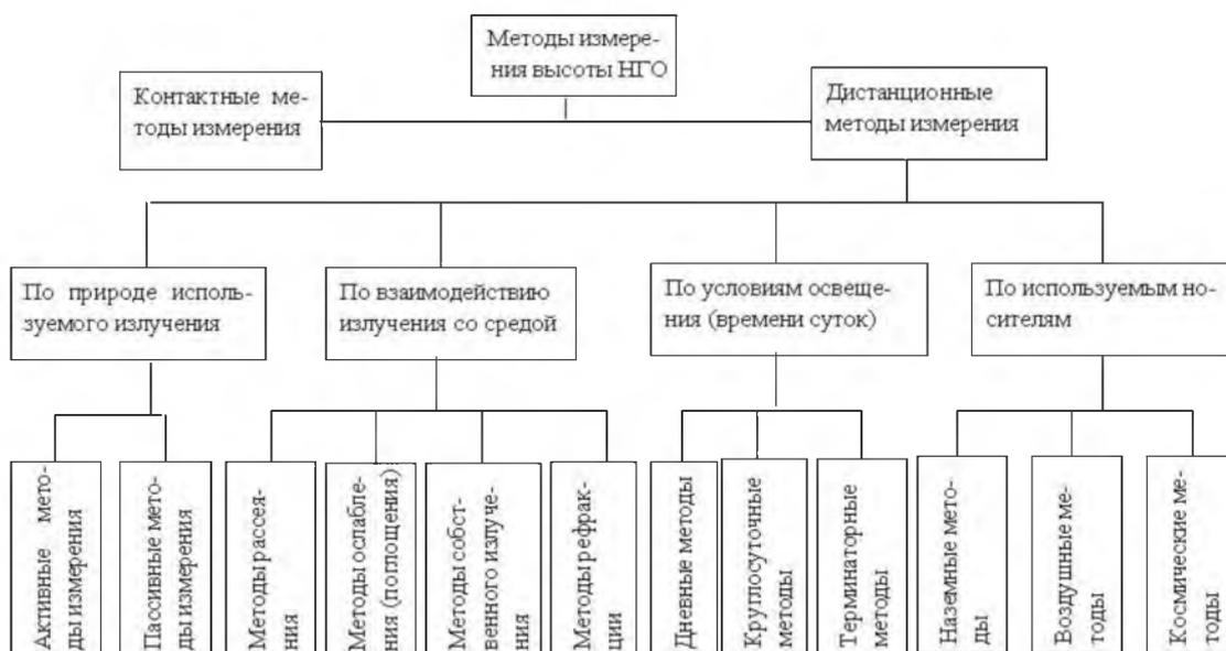
Рисунок 2.1 – Классификация методов измерения высоты НГО
