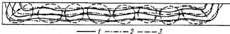
Рис. 2.2.2. Поля скоростей в открытом потоке прямоугольного сечения ( 2B/h \gg 10 ). 1 – экспериментальные данные; 2 – расчётные данные; 3 – вторичные течения.
