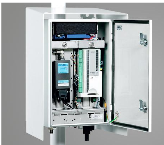
Рисунок 2.2 – Аппаратурный шкаф АДМС
