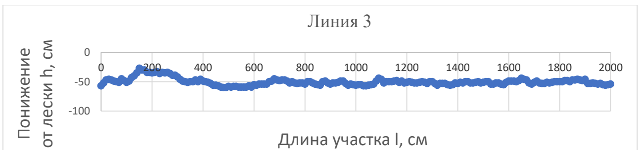
Рисунок 4.3 – расстояние от натянутой лески до поверхности болота на третьей линии таксации скважины 1076.
