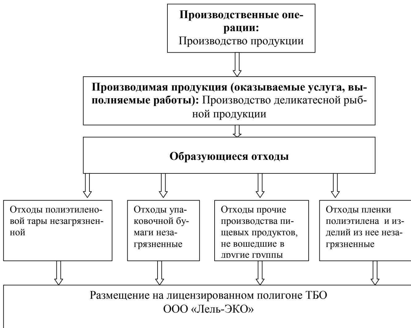
Рис. 20. Блок-схема технологических процессов по участку: производство продукции из лососевых рыб (Методические..., 2014)
