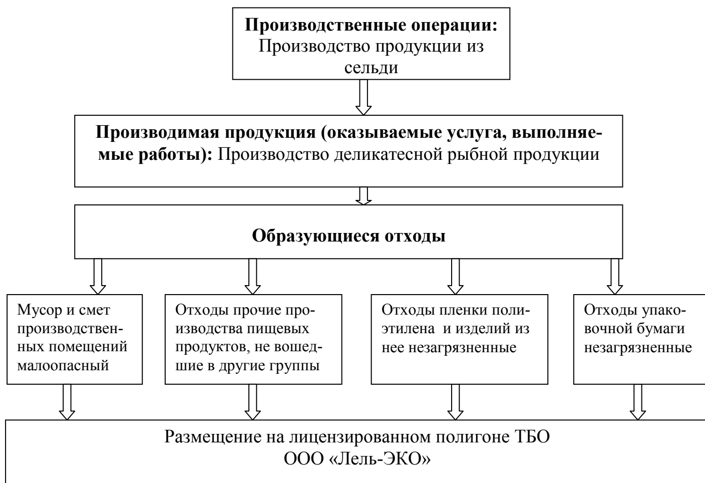
Рис. 21. Блок-схема технологических процессов по участку: производство продукции из сельди (Методические..., 2014).
