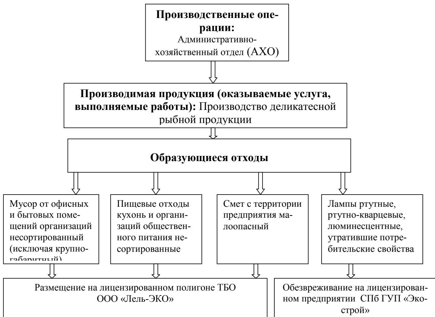
Рис. 24. Блок-схема технологических процессов по участку: АХО (Методические..., 2014).
