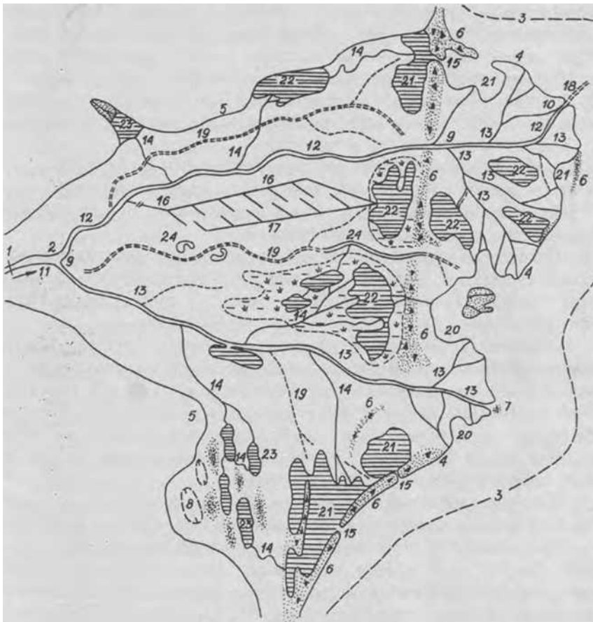
Рис. 6. Схема гидрографической сети устьевой области реки: — вершина устьевой области (устьевое участка реки), 2 — вершина дельты, 3 — морская граница устьевой области (устьевое взморье), 4 — морской край дельты; морфологические элементы: 5 — склон долины, 6 — морская коса, в том числе древняя, 7 — устьевой бар, 8 — сухая котловина, 9 — узел разветвления водотоков, 10 — узел соединения водотоков; водотоки: 11 — основное русло реки, 12 — главный рукав дельты, 13 — рукав, 14 — проток;
