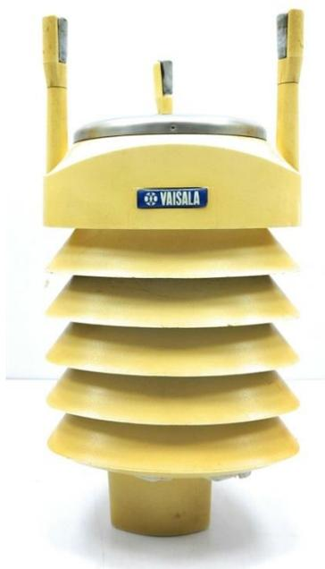
Рисунок 1.1 –Компактная дорожная метеостанция
