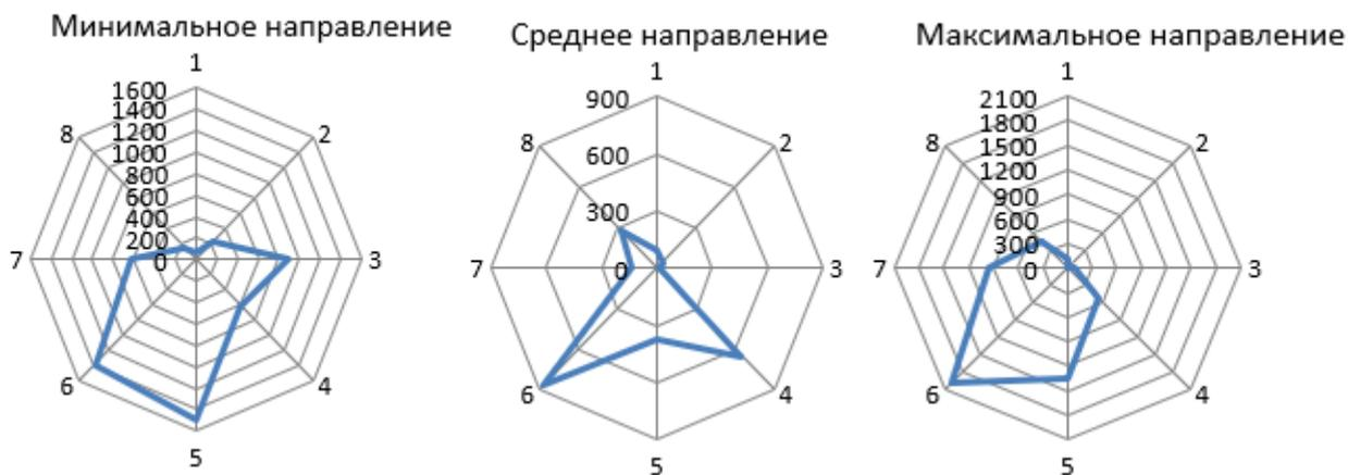
Рисунок 3.21 – Изменчивость значений направления ветра на мостовом переходе в ноябре
