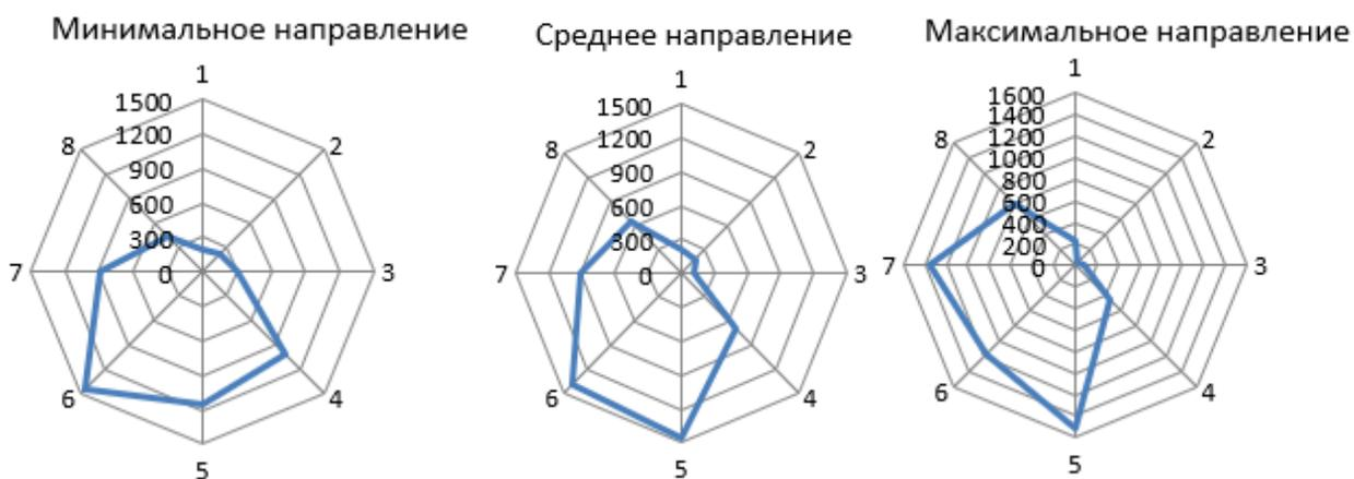
Рисунок 3.17 – Изменчивость значений направления ветра на мостовом переходе в октябре
