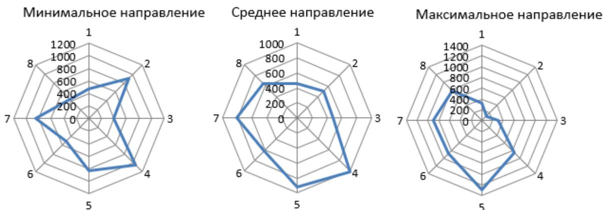
Рисунок 3.15 – Изменчивость значений направления ветра на мостовом переходе в сентябре
