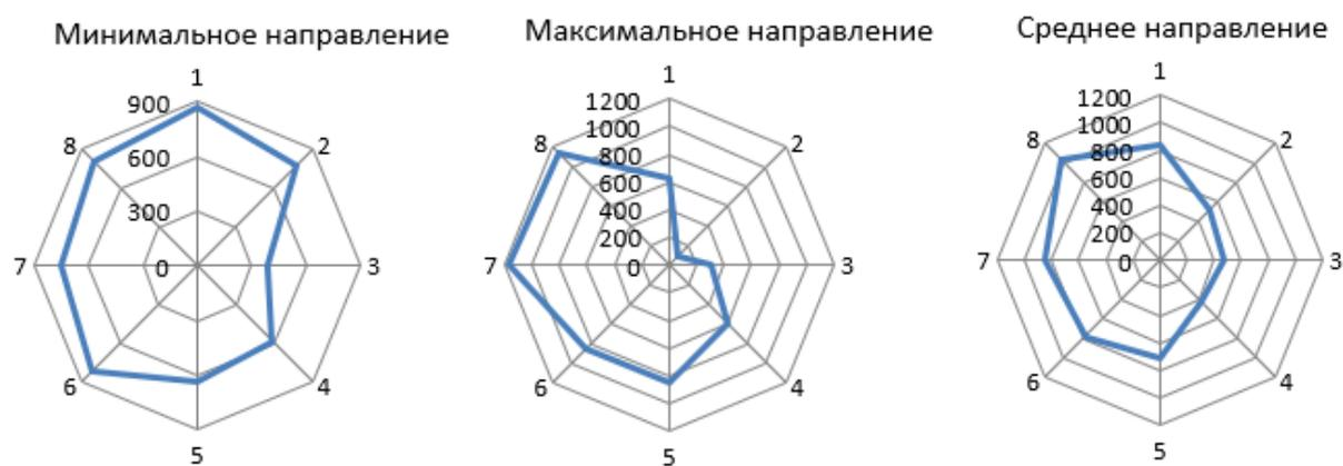
Рисунок 3.9 – Изменчивость значений направления ветра на мостовом переходе в июле
