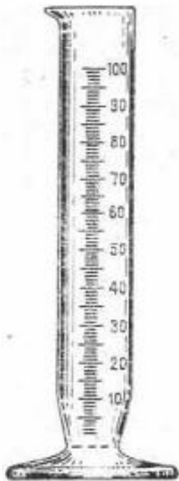
Рис.12, Измерительный стакан осадкомера
