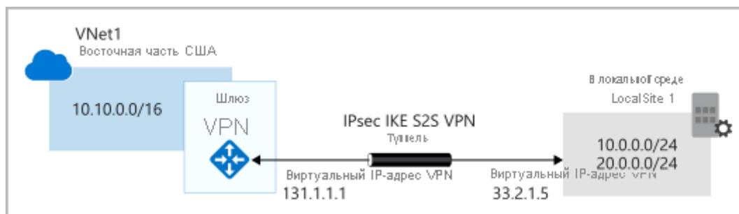
Все передаваемые данные шифруются в закрытом туннеле, который проходит через Интернет. Вы можете развернуть только один VPN-шлюз в каждой виртуальной сети, но один шлюз можно использовать для подключения к нескольким расположениям, в том числе к другим виртуальным сетям или локальным центрам обработки данных.
