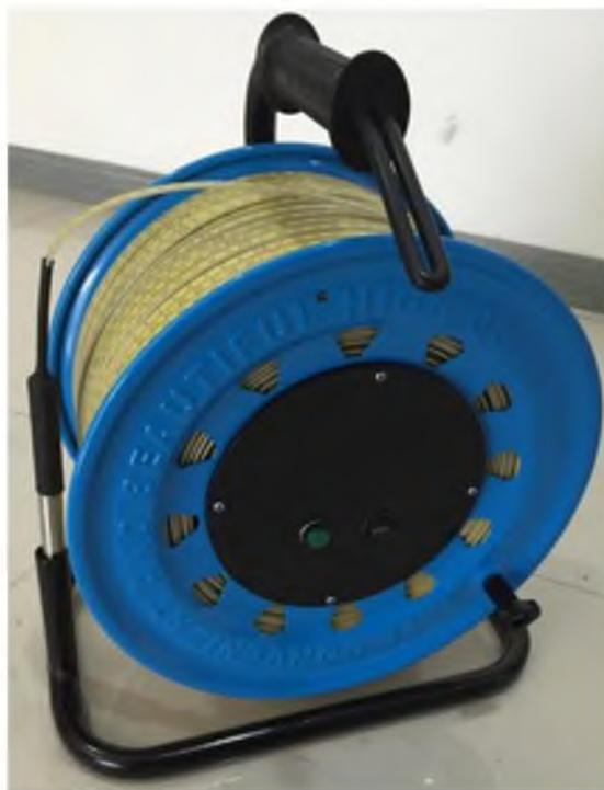
Рисунок 3.6 – Пример скважинного электроуровнемера
