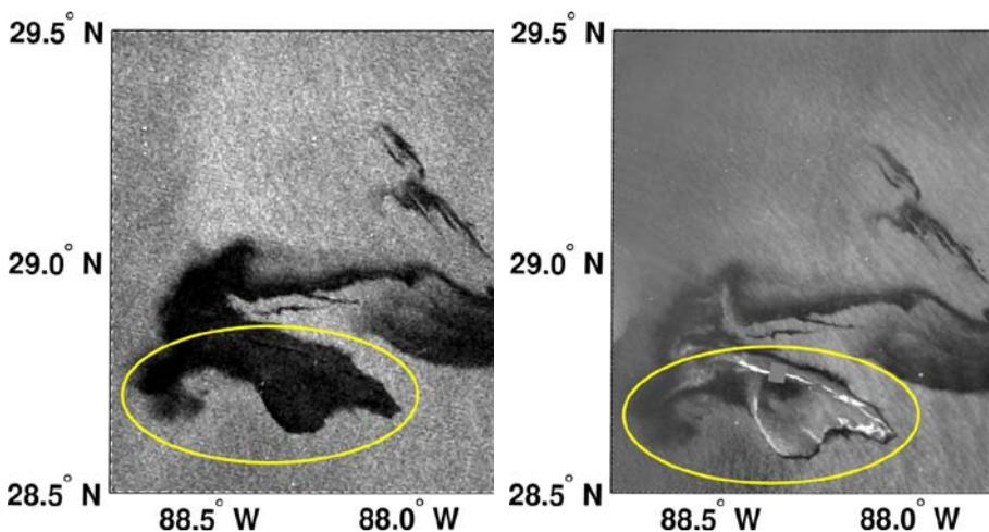
Рис. 3. Увеличенные фрагменты изображений ASAR (слева) и MERIS (справа). Изображения содержат нефтяной разлив и представлены в виде контрастов УЭПР (линейные единицы) и контрастов СКН. Толщина нефтяной плёнки в области внутри жёлтого контура значительно больше длины волны красного света.
