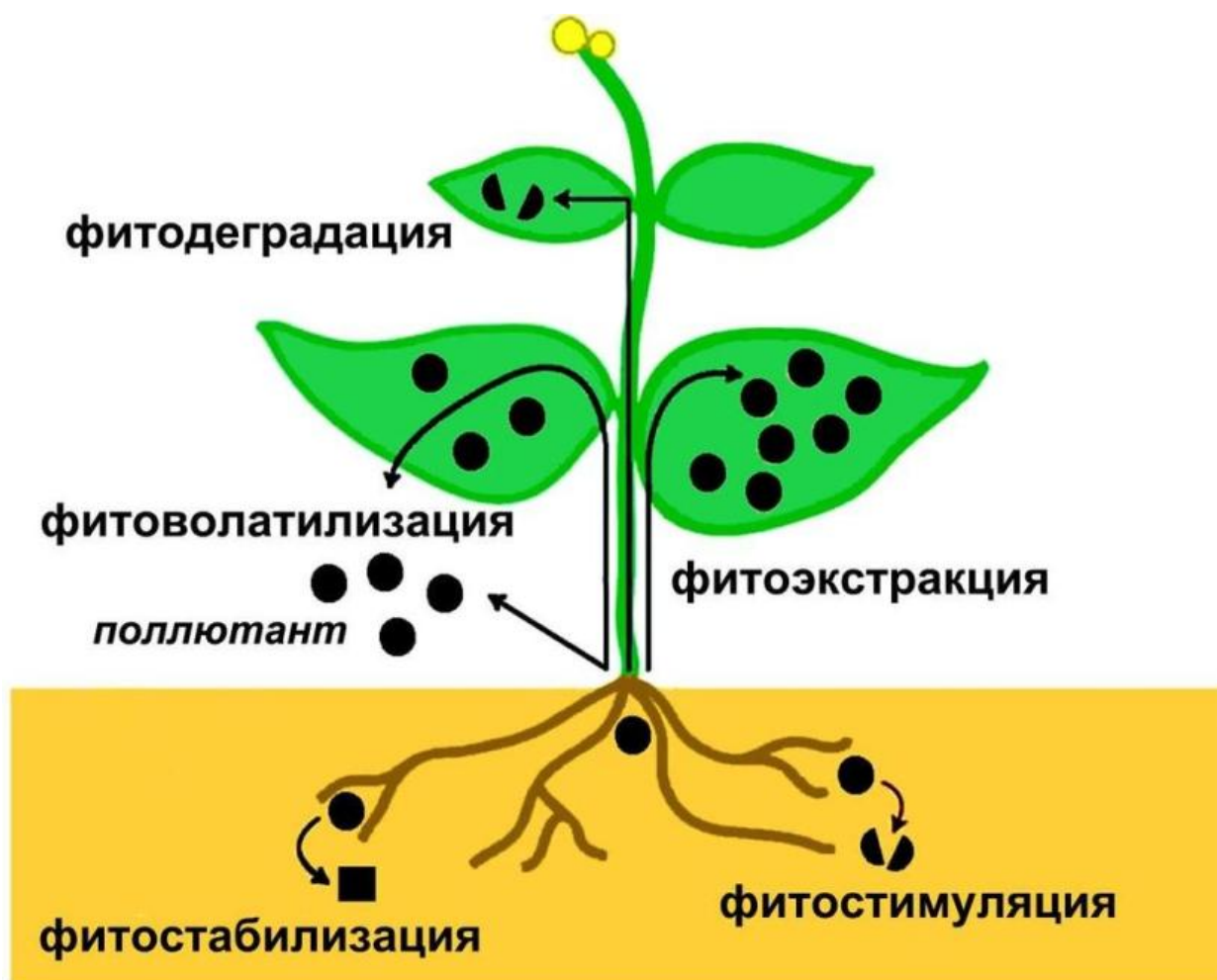
Рисунок 12. Схема механизма фиторемедиации
