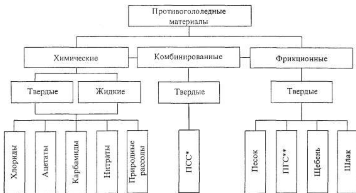
Рисунок 3.1.1 – Классификация противогололедных материалов
