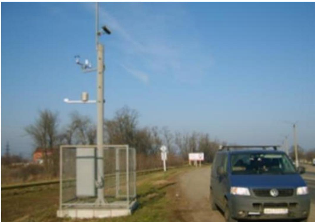
Рисунок 1.19 – Мобильная лаборатория для термокартирования
