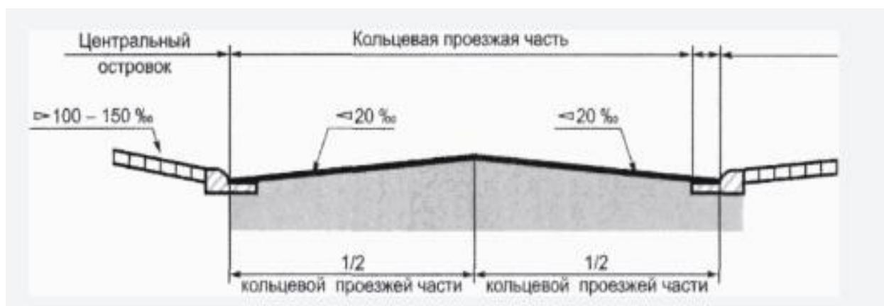
Рисунок 2.7 – Уклон дорожного полотна на кольцевой автомобильной дороге
