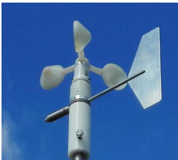
Рисунок 2.4 – Комплект датчиков ветра
