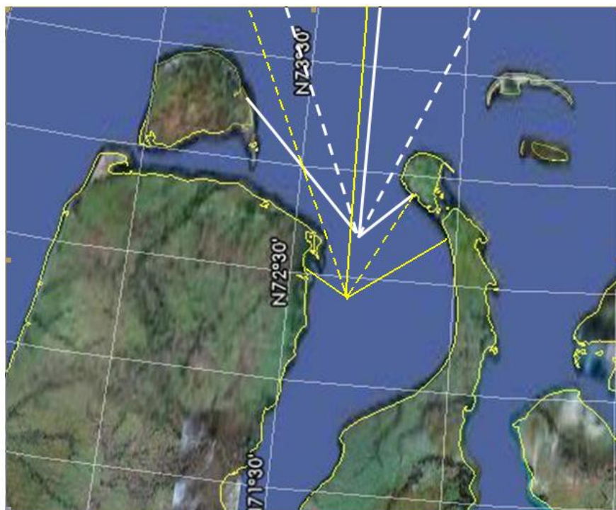
Рис.3.4. Сложные очертания береговой линии Обской губы в районе строительства (к определению эквивалентного разгона).
