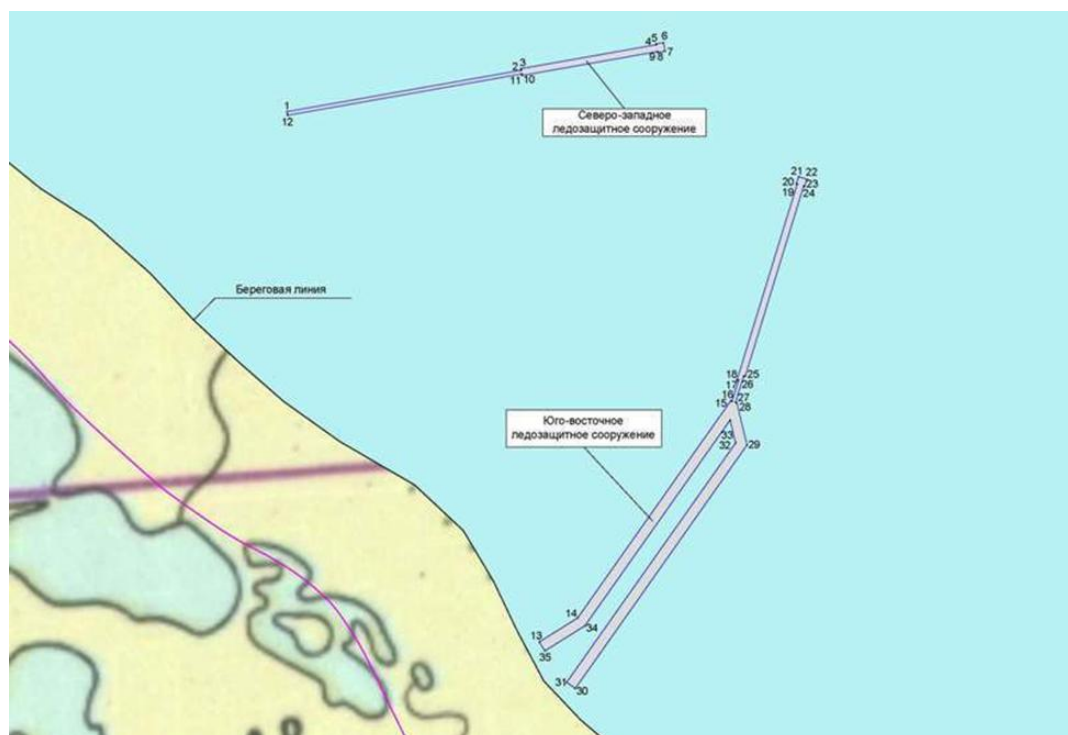
Рис.3.2. Схема ледозащитных сооружений порта Сабетта.
