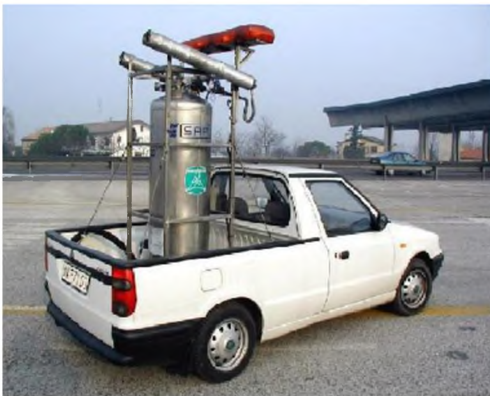
Рисунок 3.6 – Мобильный генератор мелкодисперсных частиц льда на жидком азоте [12, с. 216]
