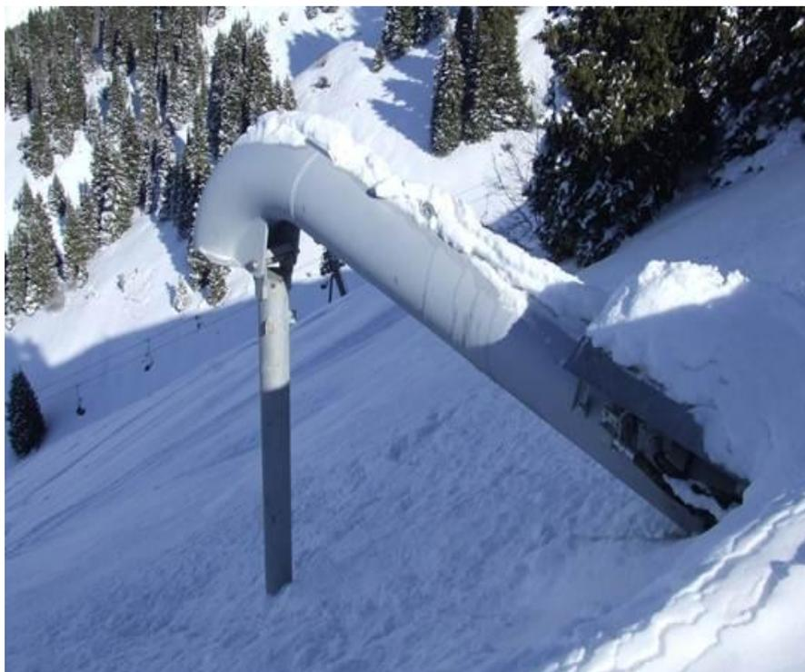
**Рис. 3.9. Газовая пушка системы «GAZ.EX»<sup>11</sup>**
