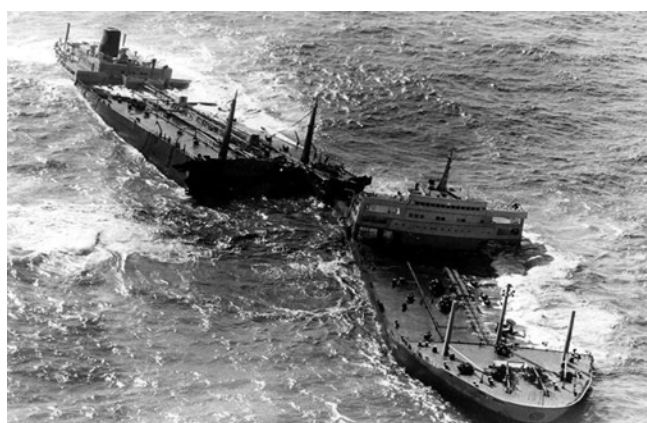
Рисунок 10. Нефтяной танкер “Torrey Canyon” расколовшийся на две части после столкновения с рифом у побережья Британии
