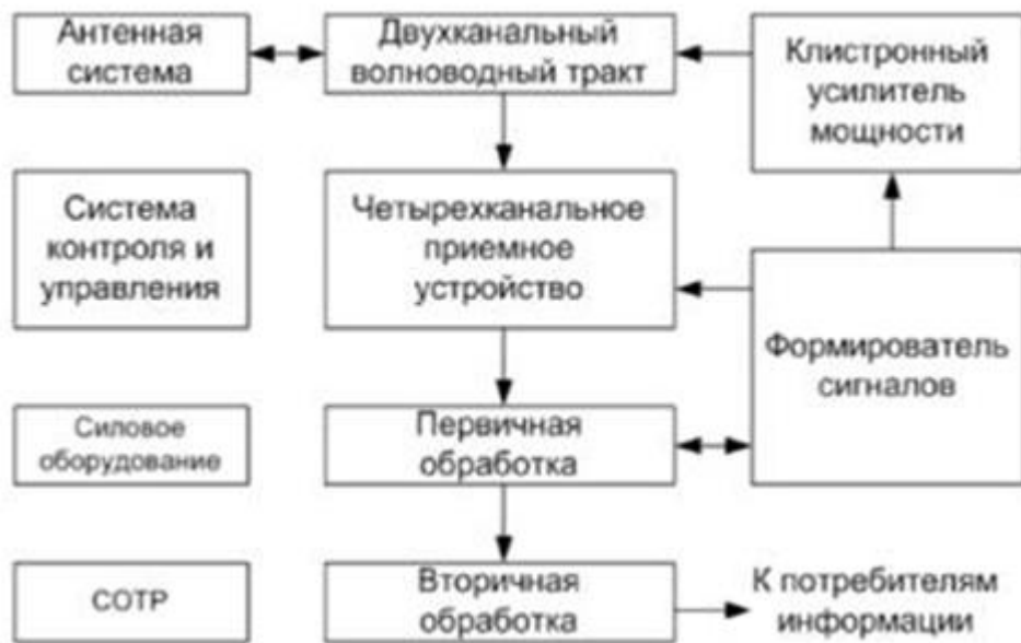
Рис. 10- Структурная схема ДМРЛ-С
