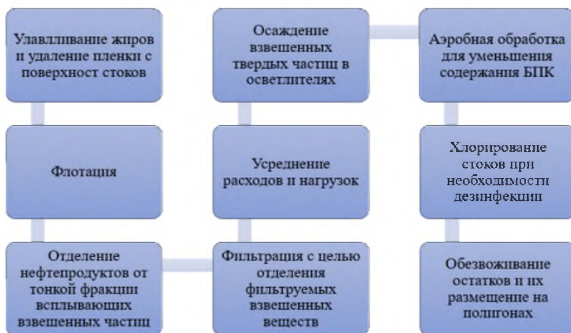
Рисунок 25 – Этапы очистки сточных вод
