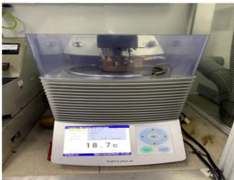
Рисунок 2.12 – Вспышка в закрытом тигле
