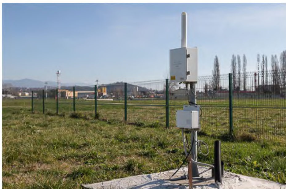
Рисунок 2.2 – Грозопеленгатор TSS928 определяет фактические разряды молний в облаках в радиусе 56 км [1]
