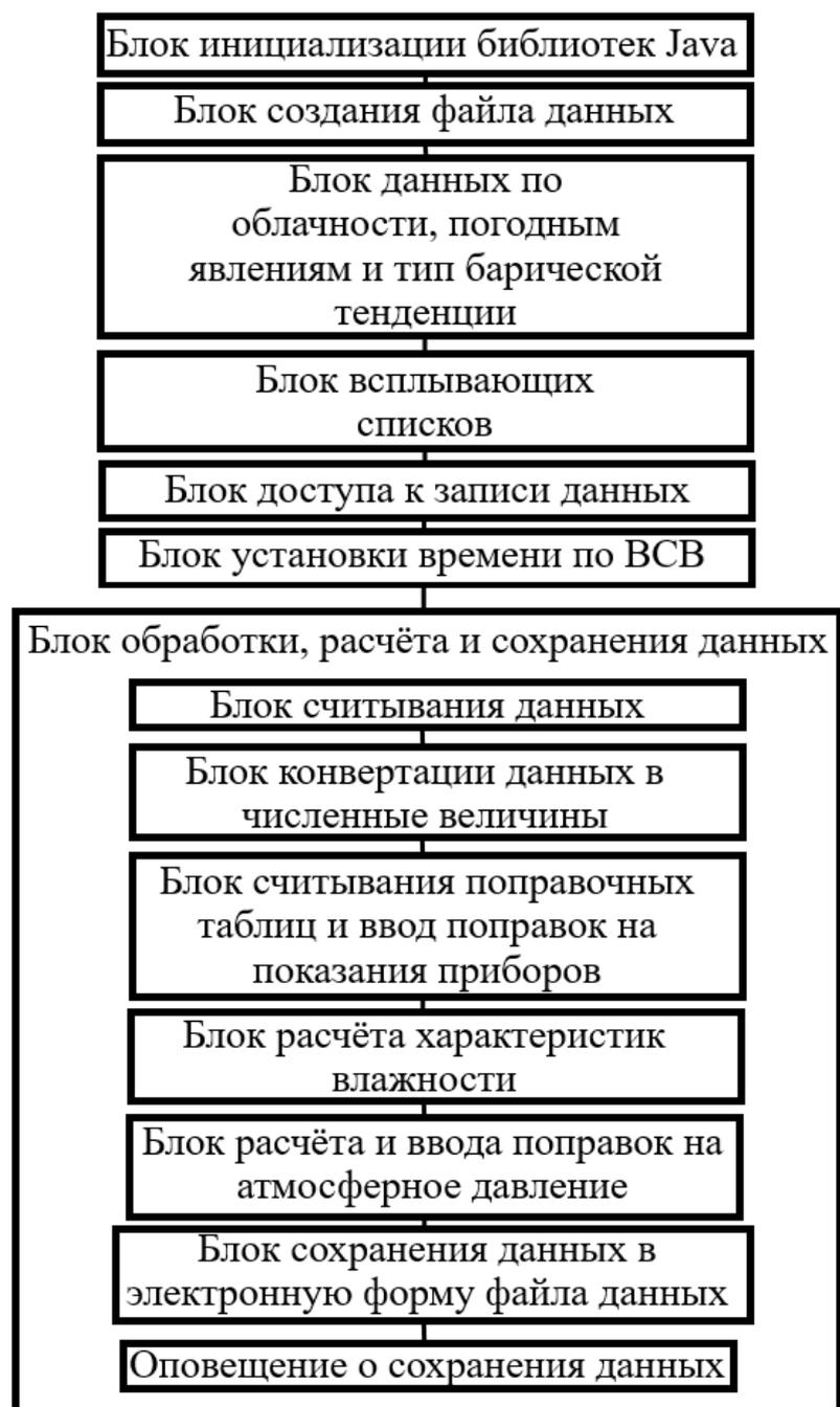
Рисунок 6 - Структурная схема мобильного программного обеспечения (Экспедиционная версия).
