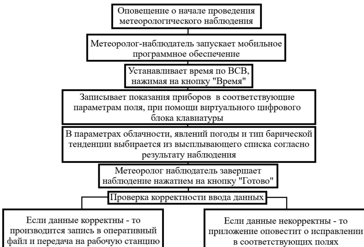
Рисунок 4 - Схема алгоритма проведения метеорологического наблюдения с применением мобильного программного обеспечения.
