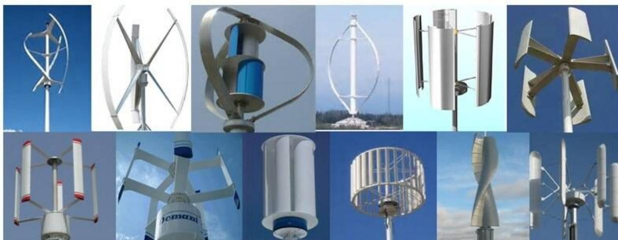
Рисунок 4. Разновидности вертикально-осевых ВЭУ
