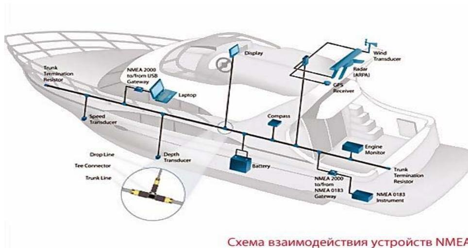
Рис.2.7 – Пример схемы взаимодействия устройств NMEA
