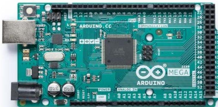
Рисунок 2.1. Плата управления подводным аппаратом (Arduino Mega 2560)
