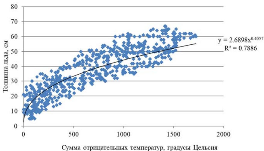
Рисунок Б.1 – Зависимость вида h_{л} = a (\Sigma\Theta)^m для р. Ветлуга – д. Кажирово
