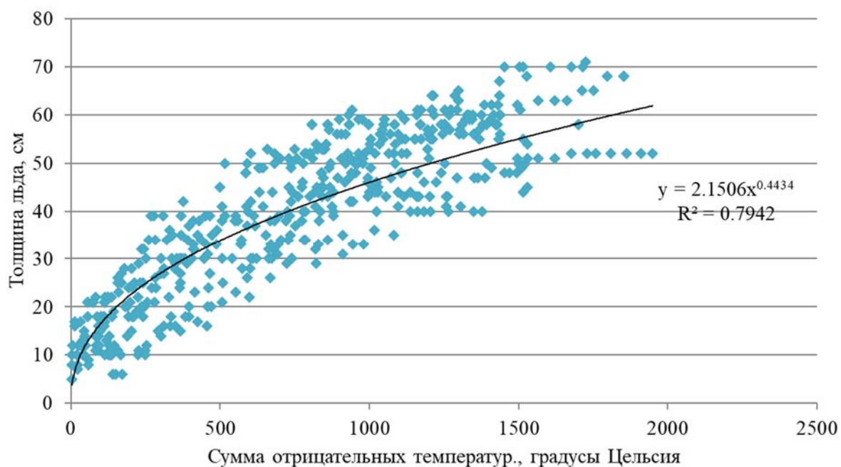
Рисунок Б.5 – Зависимость вида h_{л} = a (\Sigma\Theta)^m для р. Ветлуга – д. Шарья
