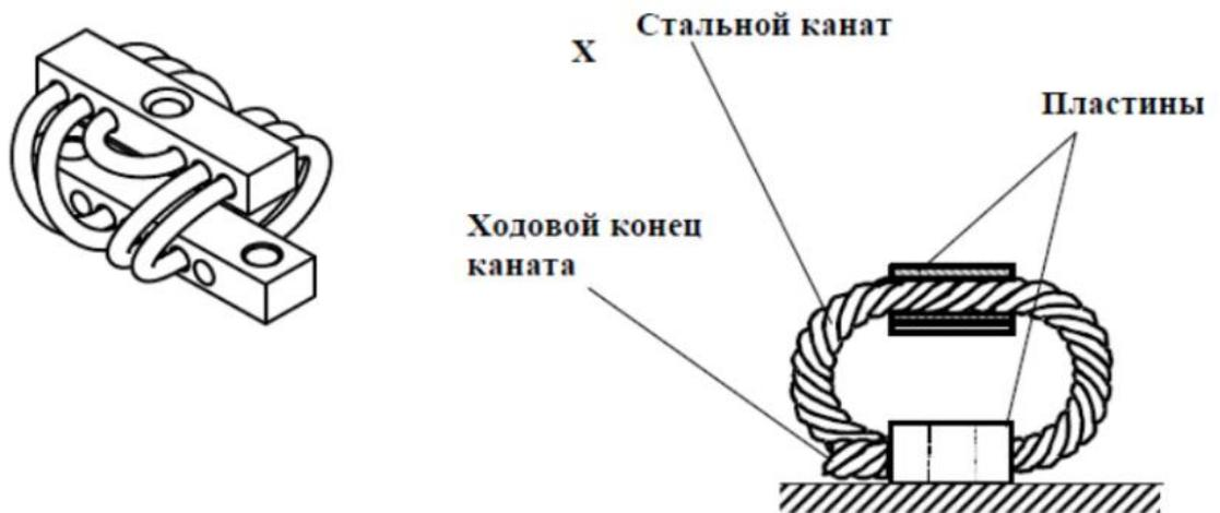
Рисунок 10 Спирально-тросовые виброизоляторы рядные
