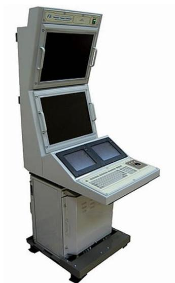
Рисунок 27 Универсальный пультовой прибор управления
