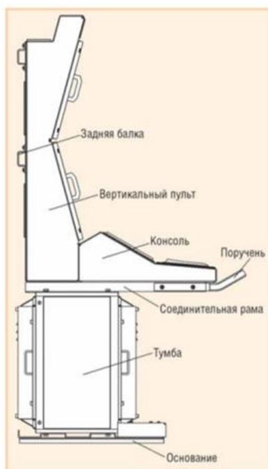
Рисунок 26 модульная конструкция
