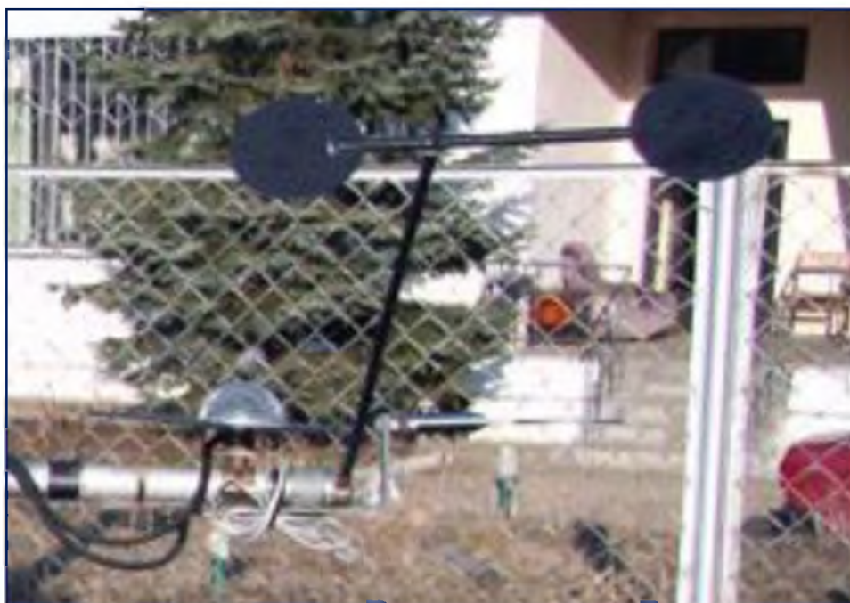
Рисунок 2.8 – Балансомер М-10М термоэлектрический
