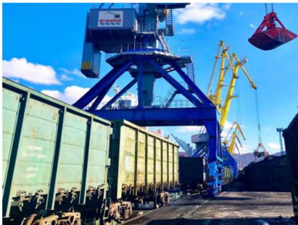
Рисунок 2.3 — Портальный кран. Разгрузка вагонов на складские площадки
