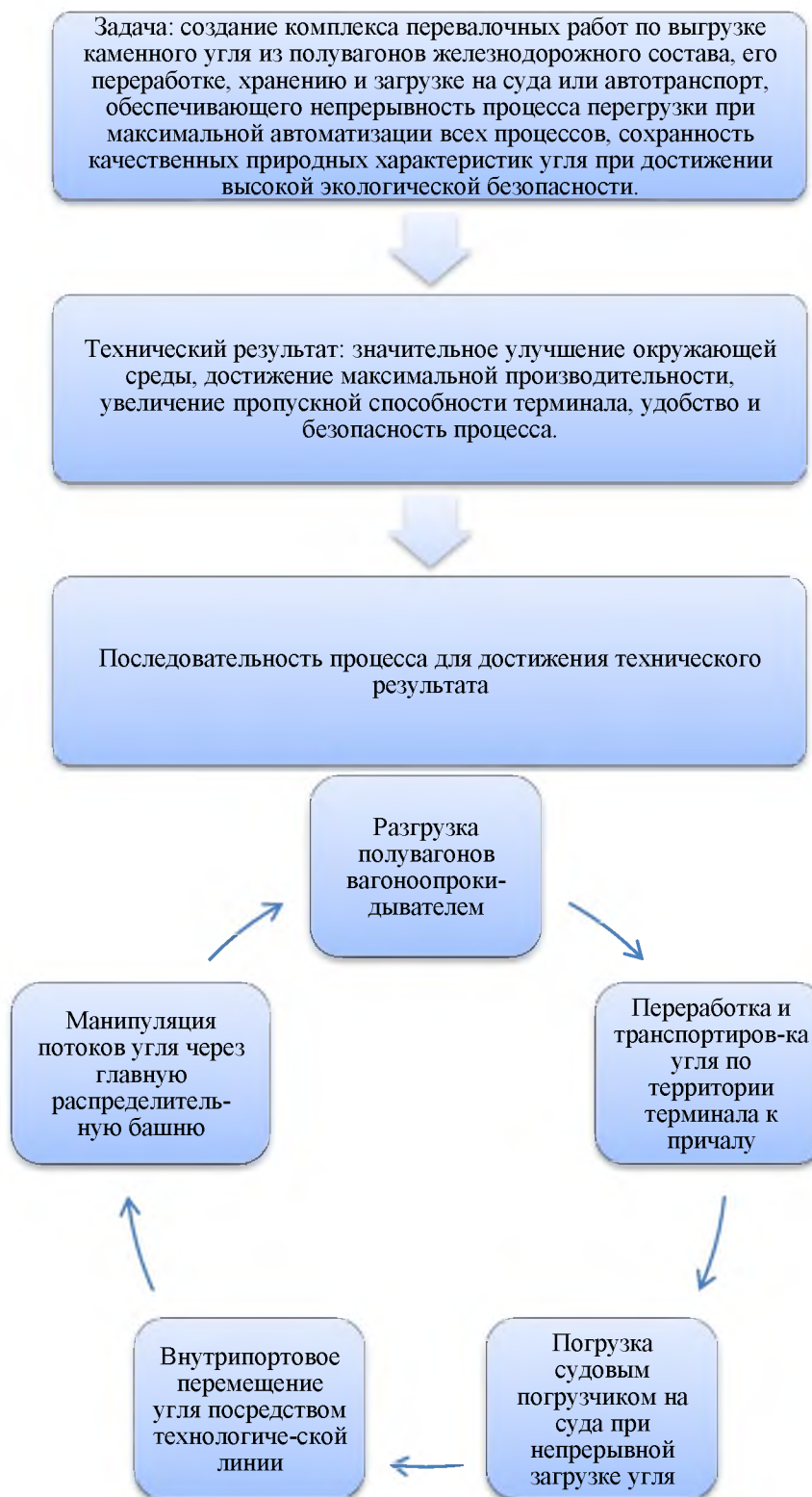
Рисунок 1.4 — Схематичное описание процесса перевалки угля из вагонов на судна
