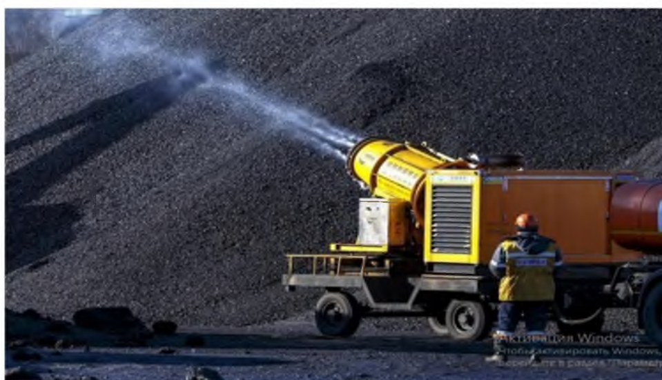
Рисунок 2.5 — Мобильная водяная пушка, обеспечивающая полноту охвата зоны пыления при смене ветра
