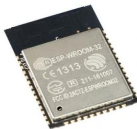
Рисунок 4ESP-WROOM-32 (Wi-Fi-модуль)
