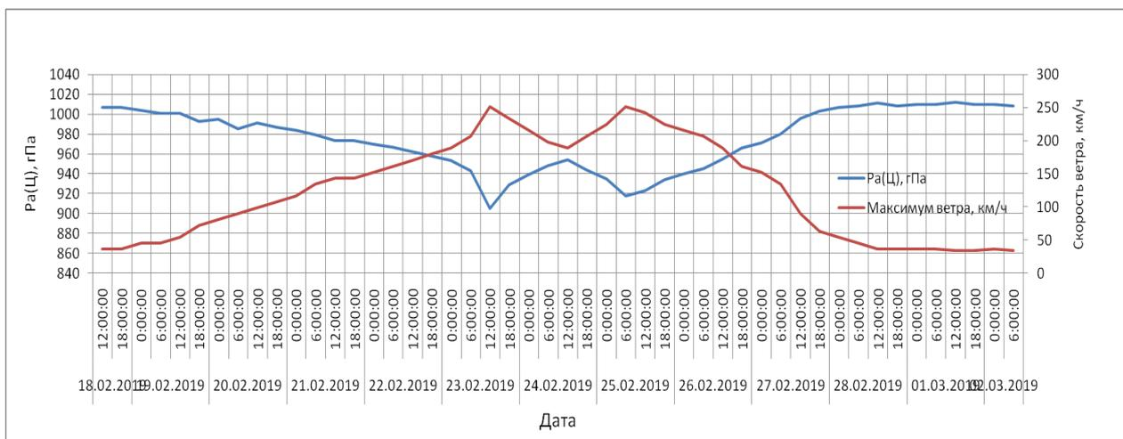
Рисунок 24 – Изменение давления и скорости ветра ТЦ Вутип.
