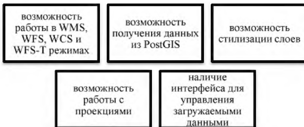
Рисунок 2.6 - Требования к картографическому веб-серверу
