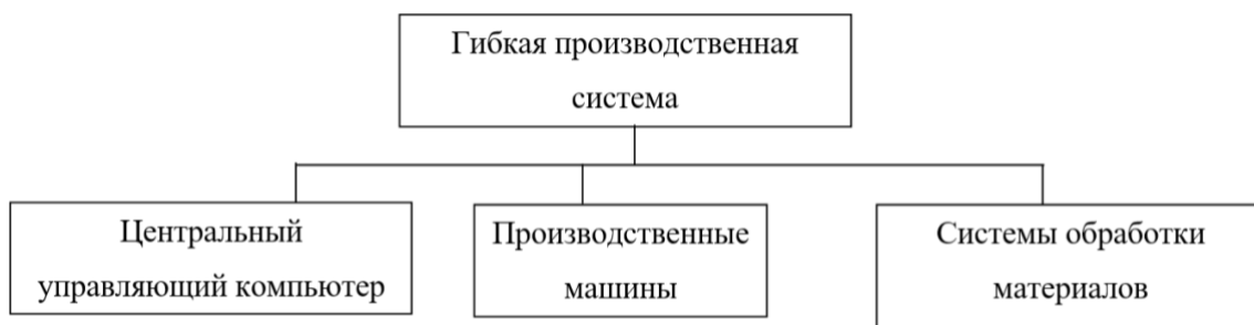
Рисунок 2 – Схема составляющих частей гибкой производственной системы
