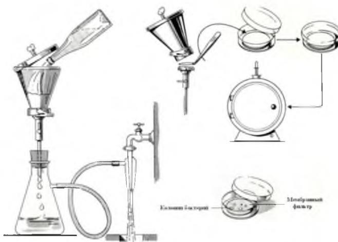
Рисунок 2.4 – Схема фильтрования барды через воронку Бюхнера при давлении
