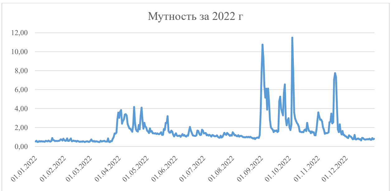
Рис. 2.5. График наблюдения мутности на водозаборе ГУП Водоканал Санкт-Петербурга «Северная водопроводная станция» за 2022 г.
