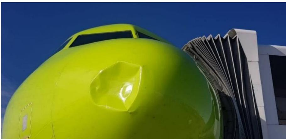
Рисунок 1.1 – Пример столкновения самолёта Airbus A320neo с чайкой в аэропорту Анадырь ("Угольный") имени Ю. С. Рытхэу
